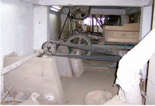
Res.30- Şamlılar Çeltik Fabrikası, Üretim-1 mahalli ve makinelere bağlı mil
