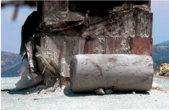
Res.14- Düz damın toprağının sıkıştırılmasında kullanılan yungu taşı
